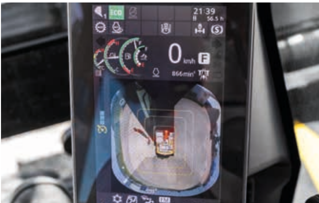
Wählen Sie zwischen verschiedenen Bildanordnungen passend zur Arbeitsumgebung.
